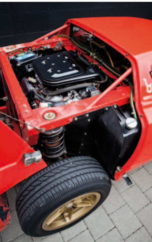
Eingebettet in einen Alurahmen leistet der V6 190 PS und 226 Nm. Nicht schlecht bei einem Leergewicht von gerade mal 980 Kilogramm.
