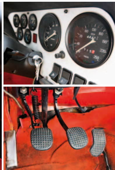
Der Tacho ist eher Nebensache. Im Mittelpunkt steht der Drehzahlmesser. Die Pedalerie ist ungewöhnlich schräg zur Sitzposition angeordnet.
