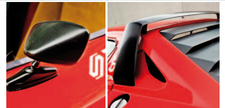
In Verbindung mit dem mächtigen Heckspoiler sorgt der schmale Dachspoiler durch seinen Abtrieb für Stabilität an der Hinterachse.
